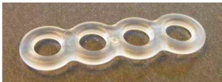
Angusslos-Produktion einer 0,1 g „schweren“ Mini-Osteosynthese-Platte unter Reinraumbedingungen auf einer speziell konfigurierten BOY XS
