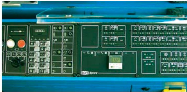
Das sprachunabhängige Bedientableau der *dipronic*-Steuerung
